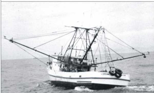
15. Embarcação de pesca industrial com casco de metal equipada para a pesca de arrasto de tangones, dirigida a camarões e linguados na plataforma do RS (M. Haimovici).
