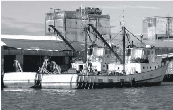
13. Parelha de embarcações de casco de metal adaptadas à pesca industrial de arrasto de fundo na plataforma do RS (M. Haimovici).
