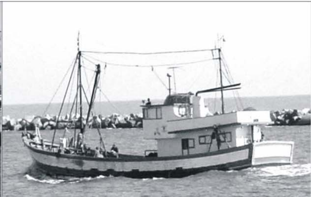
14. Embarcação de casco de madeira adaptada para a pesca industrial de arrasto de fundo com parelhas na plataforma do RS (M. Haimovici).
