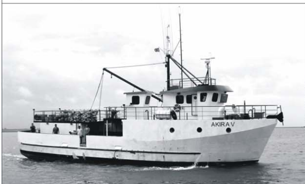
17. Embarcação de casco de aço equipada para pesca industrial de espinhel de superfície (A. Lamonaca).
