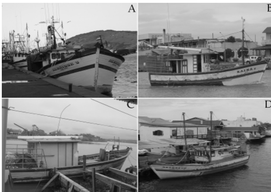
Figura 3. Embarcações da frota de Passo de Torres. A: Malheiro de grande porte com 17,6 m e motor de 290 HP. B: Malheiro de médio porte com 13,6 m e motor de 200 HP. C: Malheiro de pequeno porte com 9 m e motor de 90 HP. D: Tangoneiro com 15 m e motor de 210 HP
